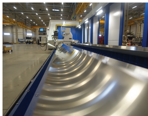
Горизонтальный токарный центр с CNC управлением и возможностью обработки деталей до 9 метров.
